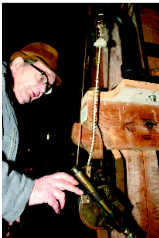
**Le guide, Eugène Jeanrenaud, présente le «Mic-Mac», un appareil à mouvement aléatoire pour le polissage de pièces avec diverses poudres**
