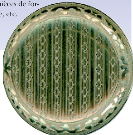
Exemple de fond de boîte. Le décor du centre est obtenu par la machine «lignes-droites». Le décor extérieur circulaire est recopié par le «métier à tapisserie».
