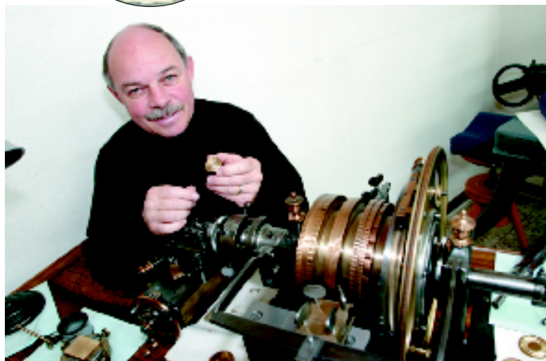
Georges Brodbeck présente un cadran réalisé sur un tour à flinquer
