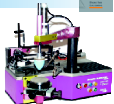
Funny Print: Machine de tampographie de haute précision pour l'horlogerie.
