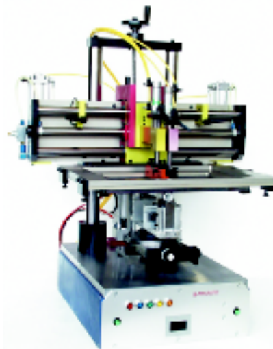
Hydrosilk GF: Machine de sérigraphie de grande précision.
